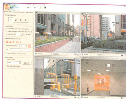
Bild 2: Eine typische Software-Konfiguration für einen Videoserver, im Bild rechts unten ist ein Motion Detection-Bereich definiert (rot)
