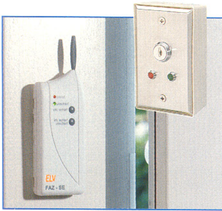
Bild 8: Die Scharfschalteinheit kann sowohl Riegel-Schaltkontakte als auch die Schaltausgänge von elektronischen Schlössern auswerten
