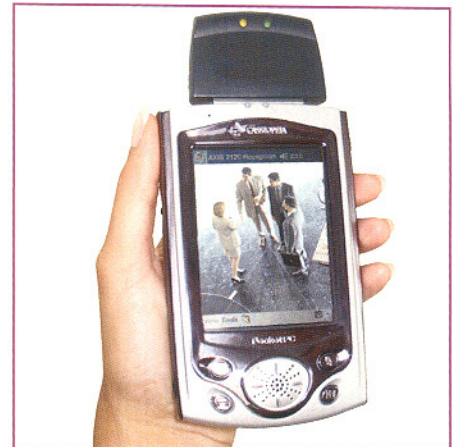
Bild 6: Auch so kann Video- überwachung aussehen - per Wireless LAN arbeitet ein PDA als Client. (Foto: AXIS)
